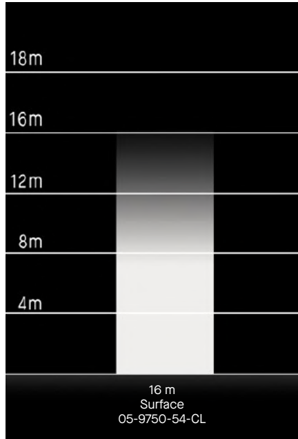
Óptica elíptica 41° x 13° (05-9750-54-CL) Ótica elíptica 41° x 13° (05-9750-54-CL)
